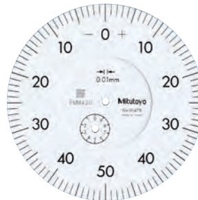
Graduación: 0.01mm Intervalo de medición: 10mm 3047S
