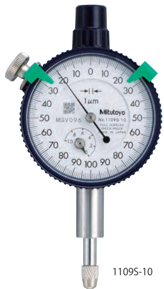
Graduación: 0.001mm Intervalo de medición: 1mm Tipo a prueba de impacto Tipo de cojinetes enjorados
