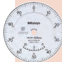
Graduación: 0.01mm Intervalo de medición: 10mm
