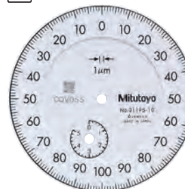
Graduación: 0.001mm Intervalo de medición: 5mm
