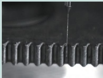
Forma de medición de los dientes del micro engrane
