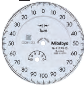
Graduación: 0.001mm Intervalo de medición: 1mm
