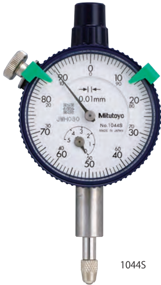
Graduación: 0.01mm Intervalo de medición: 3.5mm Tipo doble espacio en la escala
