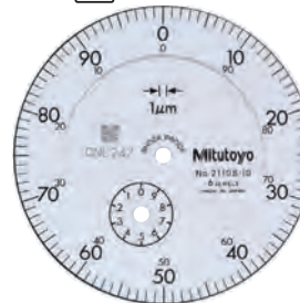
Graduación: 0.001mm Intervalo de medición: 1mm
