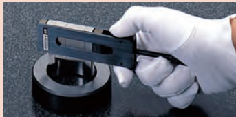
Inspeccionando un agujero usando un par de limitadores semi cilindricos y un sujetador
