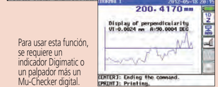
Resultado de la medición de perpendicularidad: Pantalla gráfica
