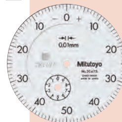
Graduación: 0.01mm Intervalo de medición: 10mm
