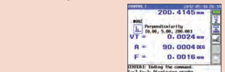
Resultado de la medición de perpendicularidad: Pantalla numérica
