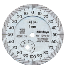
Graduación: 0.001mm Intervalo de medición: 1mm Tipo a prueba de impacto Tipo de cojinetes enjorados
